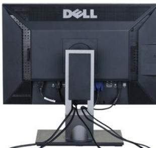
Setelah memasang semua kabel yang diperlukan ke monitor dan komputer Anda (lihat [Menghubungkan Monitor Anda](#)), gunakan slot manajemen kabel untuk mengatur semua kabel seperti yang ditunjukkan di atas.
